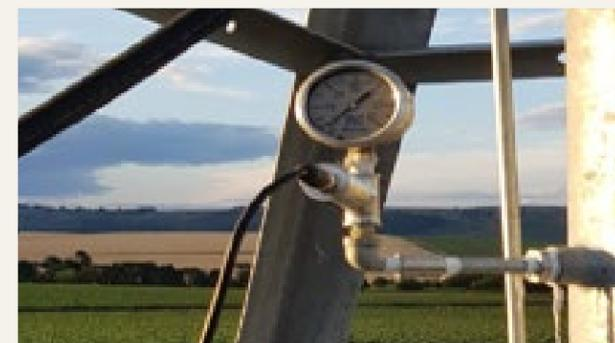
en la periferia del pivote y mediante una asociación a la carta de aspersión, se registra datos en tiempo real de posición, presión, milímetros, fallas, entre otros. Los datos registrados se pueden obtener de cualquier marca o antigüedad de pivotes y quedan almacenados por toda la temporada. Toda la información se asocia a reportes periódicos y datos exportables.
