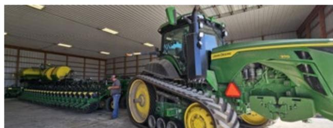
Sembradora John Deere de 54 hileras con tractor de 370HP
