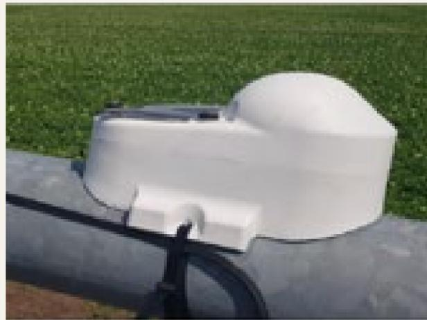
La instalación de los mismos es sencilla, no-invasiva e independiente de la marca del pivote. Toda esta información se transmite en campo mediante comunicación satelital. La plataforma procesa toda la información para detectar fallas y alertar a los productores inmediatamente, brindando la información recopilada en una APP simple e intuitiva.
